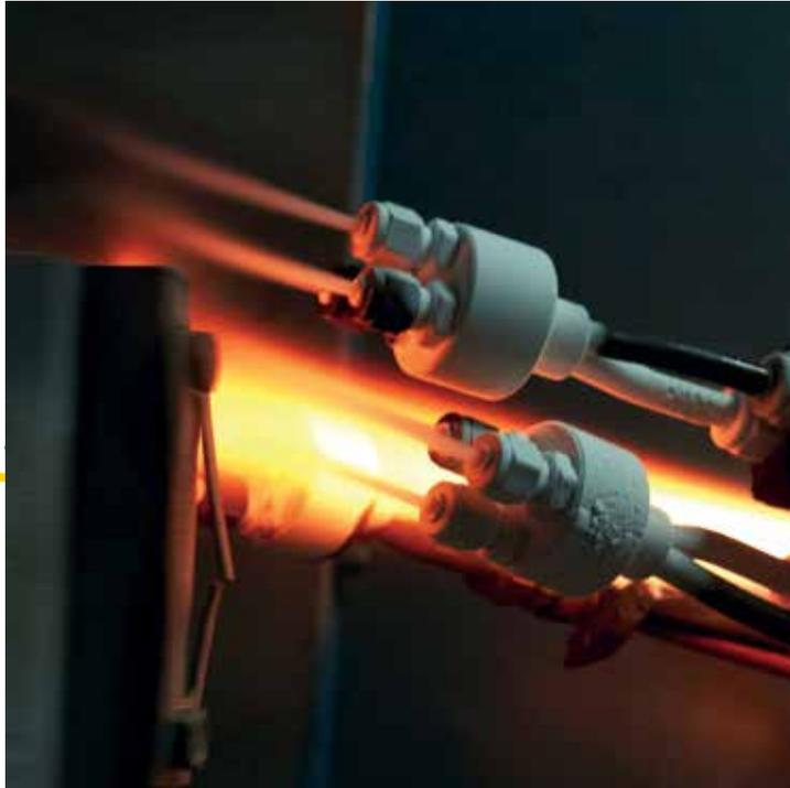
Die Düse der Air Products Kühltechnologie für das thermische Spritzen kann sowohl statisch montiert als auch am Roboterarm der Spritzpistole befestigt werden. Während des Spritzens folgt ein kryogener Gasstrahl dem thermischen Strahl und hält eine voreingestellte spezifische Temperatur am Werkstück innerhalb eines festgelegten Bereichs aufrecht.
