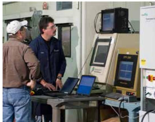
Bei der erweiterten Kühltechnologie für thermische Beschichtungsprozesse kann der Spritzprozess vom Maschinensteuerraum aus überwacht werden. Das Temperaturprofil für den Prozess wird auf dem Computerbildschirm angezeigt und für zukünftige Analysen, Wiedergaben und Prüfungen aufgezeichnet.
