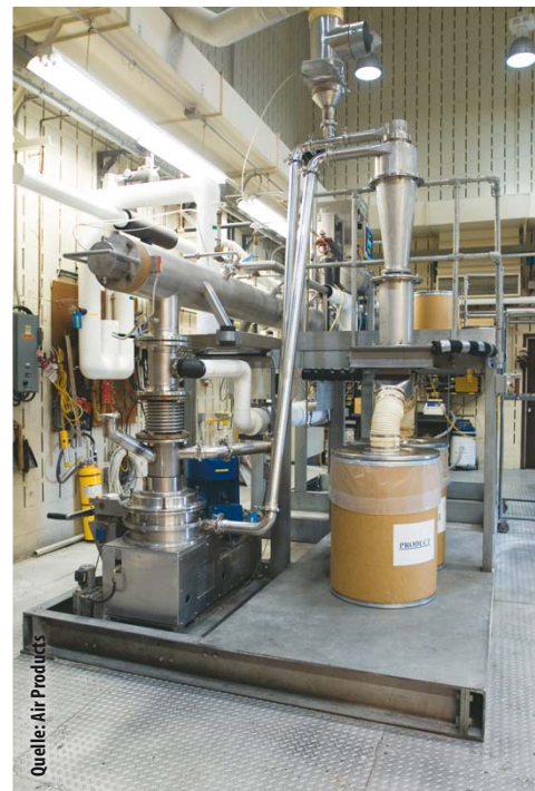
Cryogene Kühlung plus ultrafeine Vermahlung: Die Turborotorenmühle zerkleinert auf Partikelgrößen kleiner 45 Mikron.
