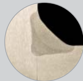
MIG-Kehlnah, AlMg-Legierung, Blechstärke 10 mm
