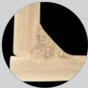
Inomaxx TM Plus Kehlnaht, 1.4404, Blechstärke 6 mm
