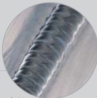
WIG-Stumpfnah, AlMg-Legierung, Blechstärke 10 mm
