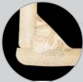
Inomaxx TM 2 Kehlnaht, 1.4404, Blechstärke 3 mm
