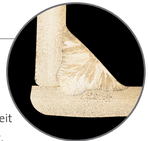
Inomaxx® 2 Kehlnaht, 1.4404, Blechstärke 3mm
