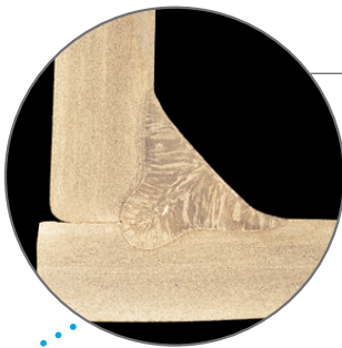
Inomaxx® Plus Kehlnaht, 1.4404, Blechstärke 6mm
