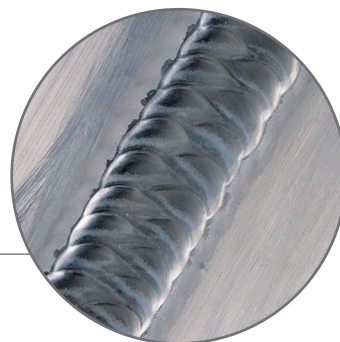
WIG-Stumpfnah, AlMg-Legierung, Blechstärke 10mm
